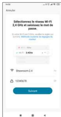
**C)** Selezionare la propria rete Wi-Fi 2.4 GHz (**attenzione: lo smartphone deve essere connesso alla stessa rete Wi-Fi a cui sarà connesso il termostato**), inserire la password di rete e toccare **SUIVANT** (Successivo).
