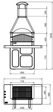
Barbecue realizzato con materiali altamente refrattari. Focolare e piano lavoro in "ROSA ASIAGO", piano lavoro con finitura lucida CRYSTAL. Completo di pianetti in refrattario per una maggiore protezione termica e di griglia cromata posizionabile su tre livelli. Facilmente assemblabile con colla SUNDAY® BETONFAST acquistabile separatamente nella gamma accessori. Utilizzabile con carbonella e legna.
